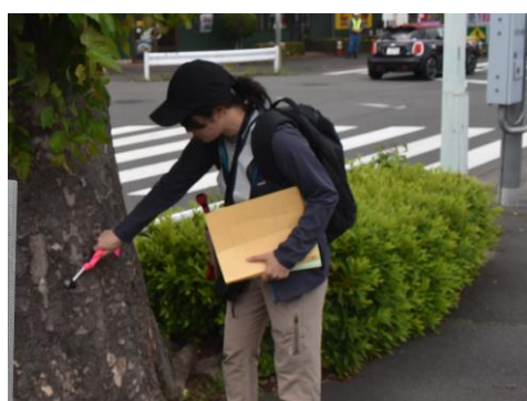
打診による腐朽の確認
