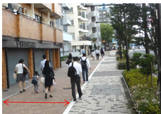
歩道有効幅員約3.5m
