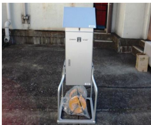
ハイボリューム・エアサンプラーによる総浮遊粉じん濃度測定
