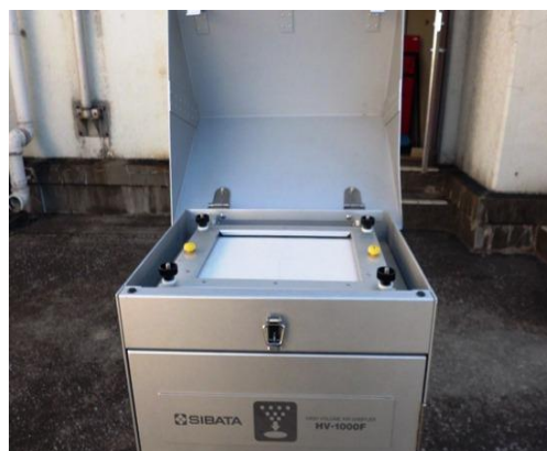
ハイボリューム・エアサンプラーによる総浮遊粉じん濃度測定
