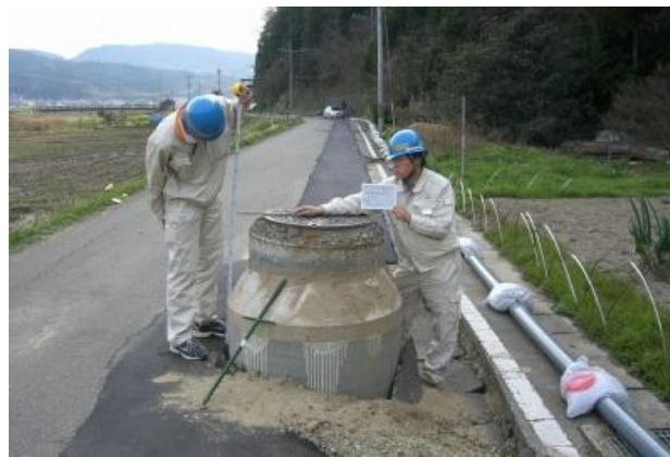
図2-14 被災によるマンホールの突出状況(平成19年能登半島地震)
