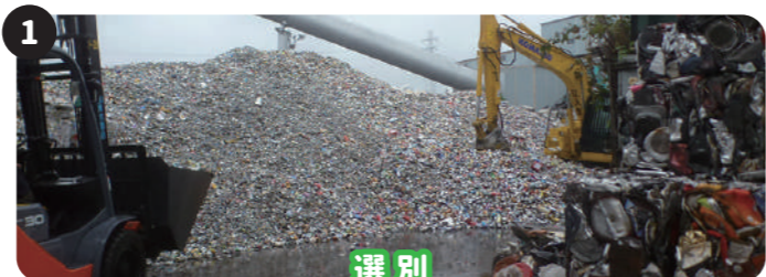
1 選別 磁石を使ってアルミ缶とスチール缶を選別
