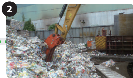
2 選別されたアルミ缶を金属圧縮機へ投入
