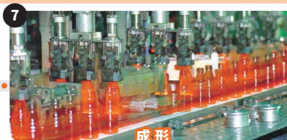
7 成形 金型に入れてびんの形に成形 いつどこでつくられたのか、びんの底にマークがつく
