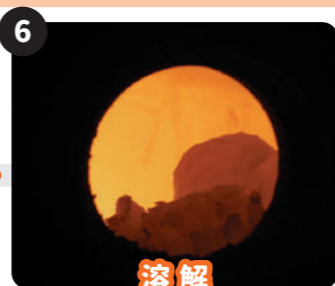
6 溶解 調査された原料は溶解炉の中へ投入 され、約1,500°Cの高温で溶解して ガラスを作る
