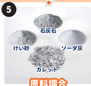
5 原料調合 カレットとけい砂・石灰石・ソーダ灰 などの天然素材をミキサーで均一な 状態になるまで混ぜ合わせる
