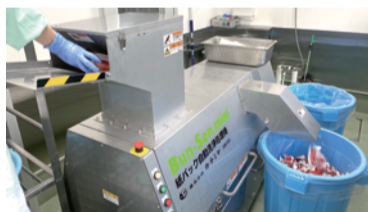
自動洗浄処理機での破碎・洗浄作業
